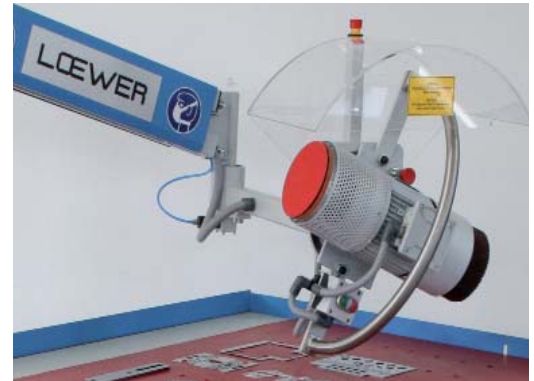
Schwenkbare Schleifkopf 180 Grad für schnelle Verfügbarkeit von Entgrat- und Verrundungswerkzeug
