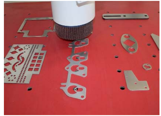
Gelochte Spezial-Aufkagematte mit hoher Haftkraft zum Bearbeiten sehr kleiner Teile
